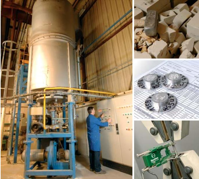
Pour parfaire notre développement, la réduction des coûts de fabrication et contribuer à la protection de l'environnement, nous sommes équipés d'une unité de régénération thermique de sable. Notre capacité de traitement de sable est de 0,5 tonne/heure, répondant à la nature de l'activité considérée et permettant la combustion des composants organiques du sable. Nous réduisons ainsi notre empreinte écologique de 150 tonnes de sable mensuel à 50 tonnes annuel.
